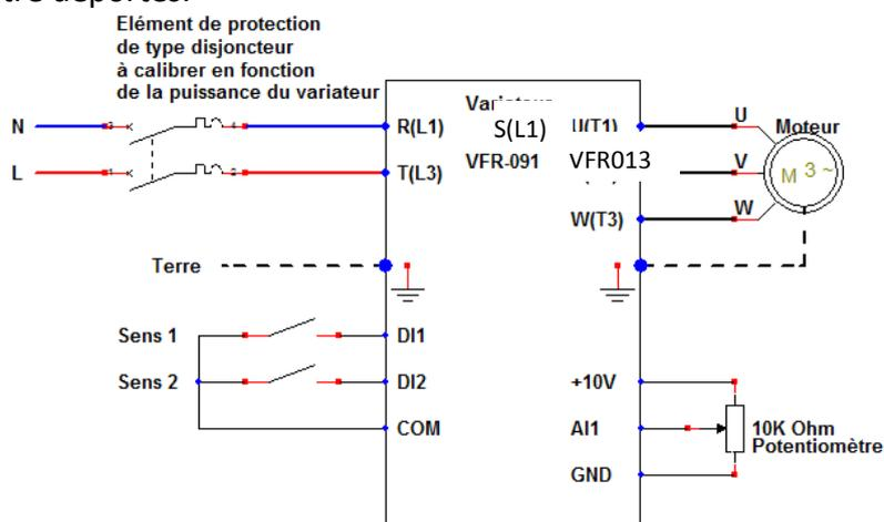
Exemple de câblage avec un variateur Mono-Tri. Existe aussi en Tri-Tri.
