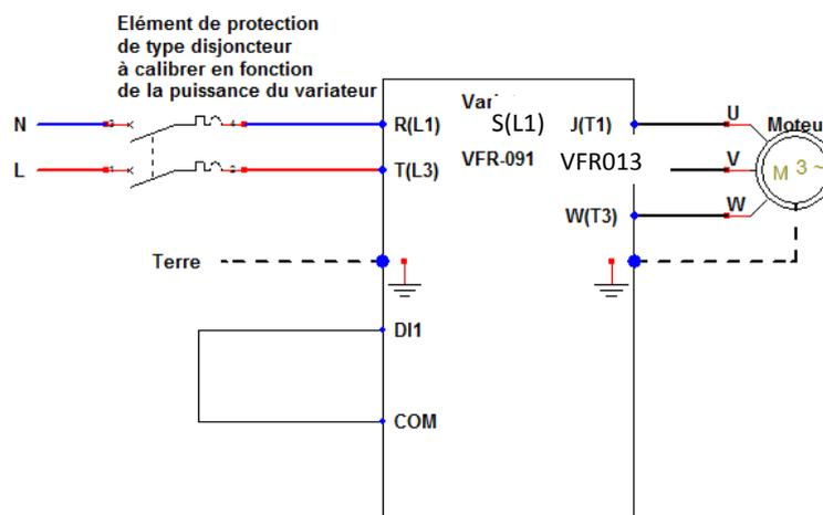
Exemple de câblage avec un variateur Mono-Tri. Existe aussi en Tri-Tri.
