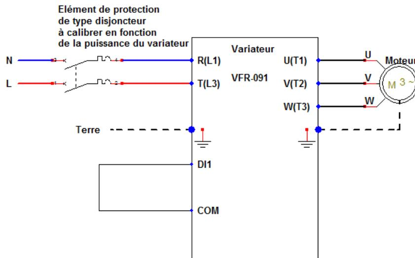
Exemple de câblage avec un variateur Mono-Tri. Existe aussi en Tri-Tri.
