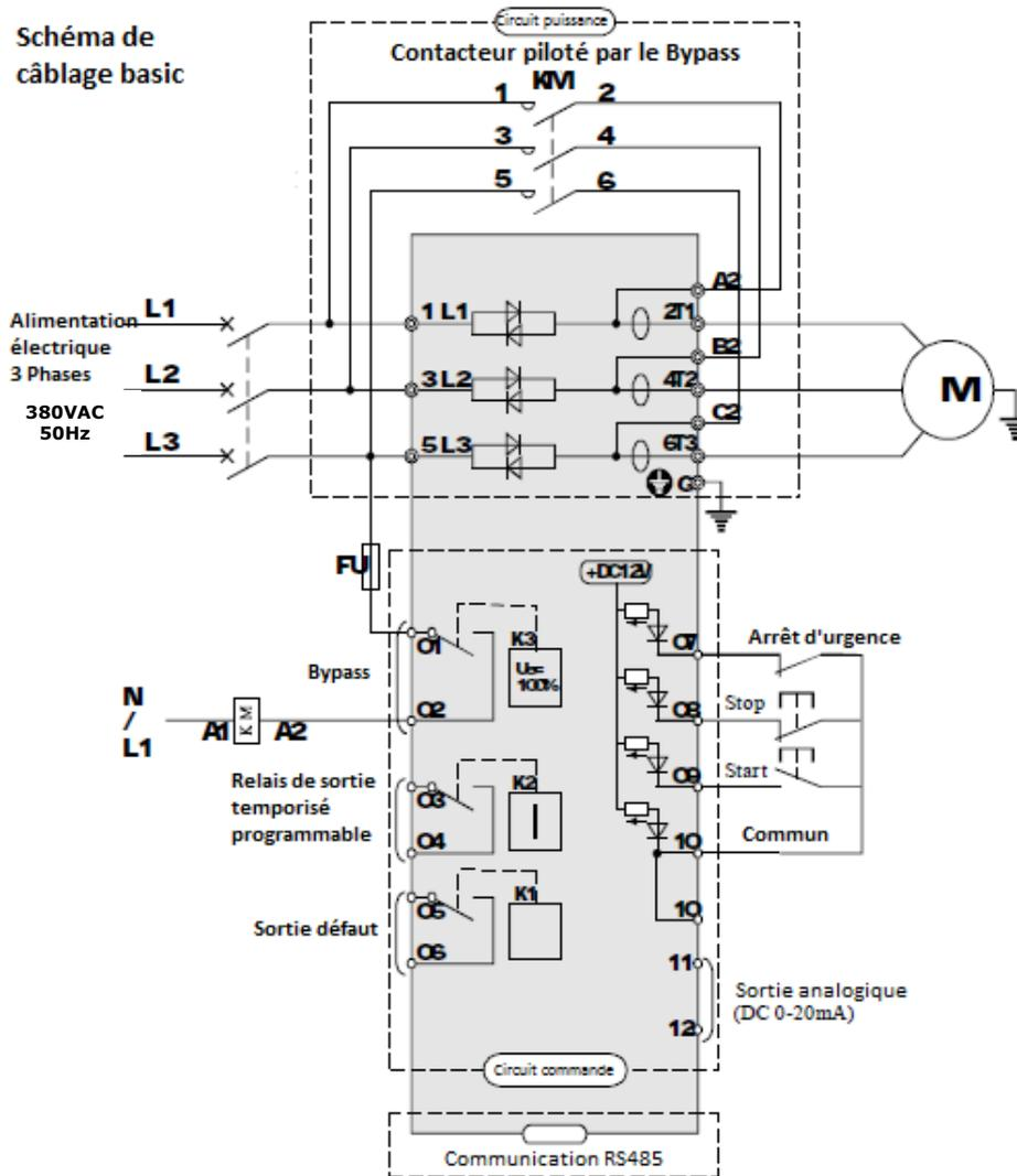
Le tableau suivant décrit le câblage du circuit de puissance des démarreurs progressifs de la série **SST-002**.
